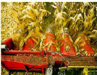
Давно созревшая кукуруза аккуратно обработана сквозь пластины початкоотделителя...
