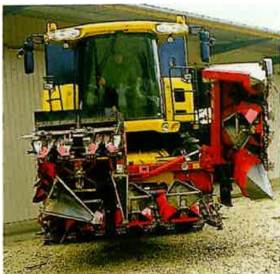
Жатка вовсе не мешает широте обзора. Транспортная ширина составляет 3,20 м.
