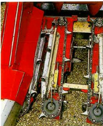
Положение початкоотделительных пластин регулируется электрически. Заявки только по желанию.
