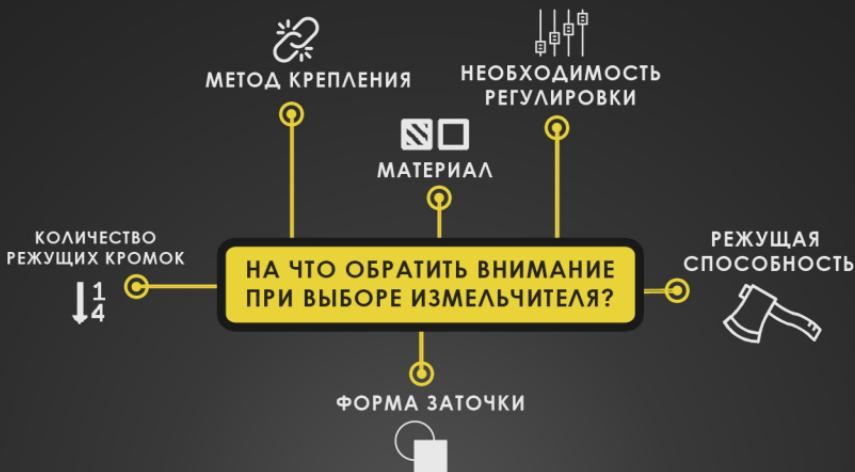
1. Метод крепления – определяет скорость установки/снятия ножей. Чаще всего ножи крепятся винтами, их количество от одного до четырех для ножа. Чем меньше винтов – тем быстрее смена
