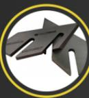
С ДИАГОНАЛЬНОЙ ЗАТОЧКОЙ НОЖИ ИЗГОТОВЛЯЮТ ДЛЯ ТОГО, ЧТОБЫ НОЖ ПРОНИКАЛ В ДРЕВЕСИНУ НЕ РАЗОМ ПО ВСЕЙ ШИРИНЕ, А ПОСТЕПЕННО. В РЕЗУЛЬТАТЕ СНИЖАЕТСЯ СОПРОТИВЛЕНИЕ РУБКЕ, УВЕЛИЧИВАЕТСЯ ПРОИЗВОДИТЕЛЬНОСТЬ, СНИЖАЮТСЯ ТРЕБОВАНИЯ К МОЩНОСТИ. СЛОЖНОСТЬ ЯВЛЯЕТСЯ ПОДДЕРЖАНИЕ ЗАДАННОГО ЗАВОДОМ УГЛА ЗАТОЧКИ, ДА И ПРИМЕНЯЮТСЯ ПОДОБНЫЕ НОЖИ, ПОЖАЛУЙ, ТОЛЬКО НА ИЗМЕЛЬЧИТЕЛЯХ ПРОФЕССИОНАЛЬНОГО УРОВНЯ.
