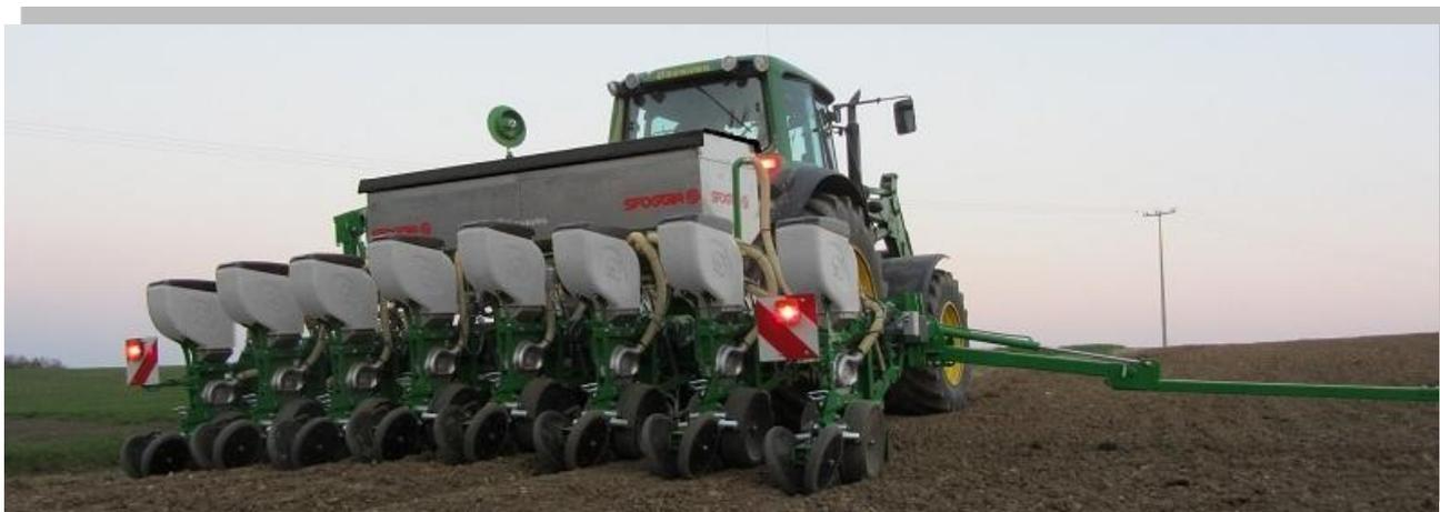
**SIGMA ELEKTRA** - пневматическая сеялка точного высева. Предназначена для высева семян как в обработанную, так и в необработанную почву. Прочная конструкция сеялки, удобство и гибкость эксплуатации, а также соблюдение всех параметров посева позволяют использовать сеялку на скорости 10- 12 км/ч. Двойные дисковые сошники и специальные боковые колеса каждой высевальной секции гарантируют постоянную глубину заделки семян даже при изменяющемся характере и структуре почвы.
