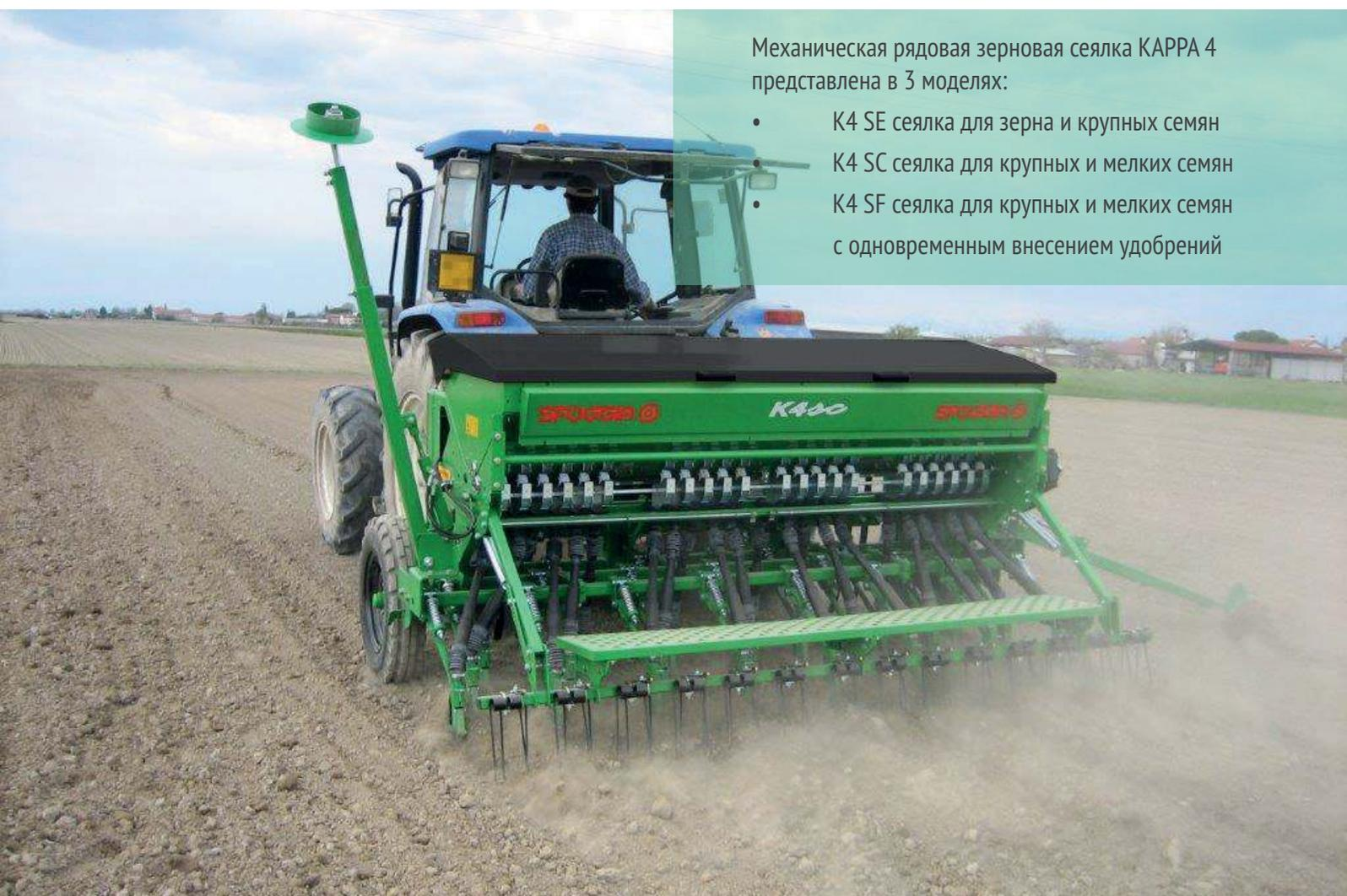
Механическая рядовая зерновая сеялка KAPPA 4 представлена в 3 моделях:
