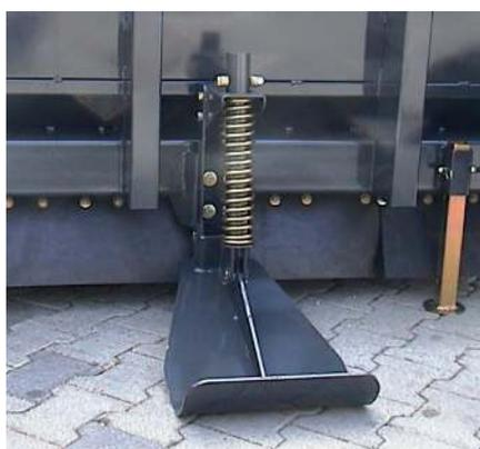
Плющилка стебля позволяет избежать повреждения шин комбайна стерней
