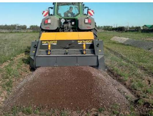
Трамбующие пластины для выравнивания поверхности обработанной земли
