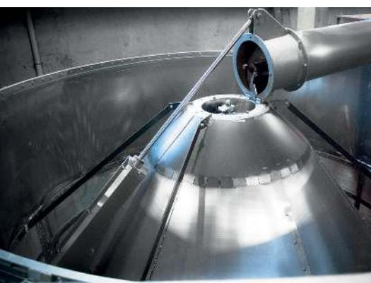
Центральный шнек с наплавкой из стали Hardox
