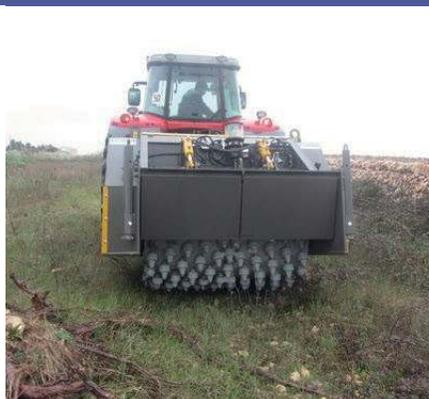
Ротор расположен ниже плоскости опор оборудования
