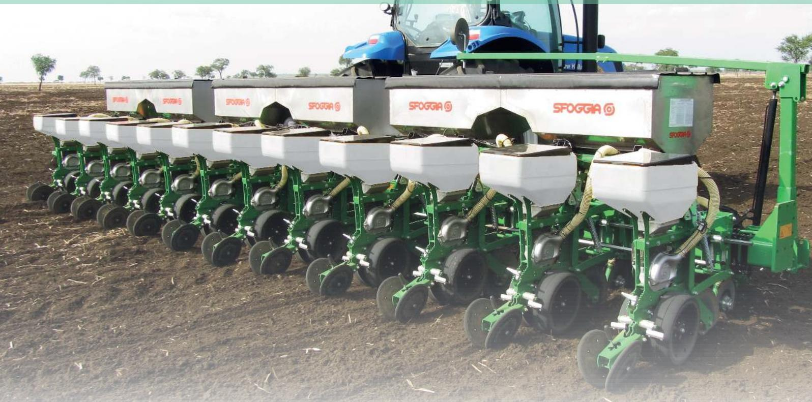
Флагман серии пневматическая пропашная сеялка Sigma 5. Предназначена для высева семян как в обработанную, так и в необработанную почву (при наличии остатков культур используется специальный набор). Прочная конструкция позволяет использовать сеялку на скорости до 12 км/ч. Двойные дисковые сошники и специальные боковые колеса каждой высевальной секции гарантируют постоянную глубину заделки семян.
