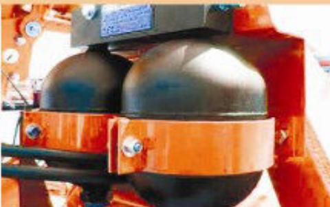
ОХЛАЖДЕНИЕ ГИДРАВЛИКИ, АЗОТНЫЙ АККУМУЛЯТОР
