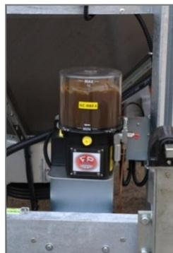
Автоматическая смазка узлов
