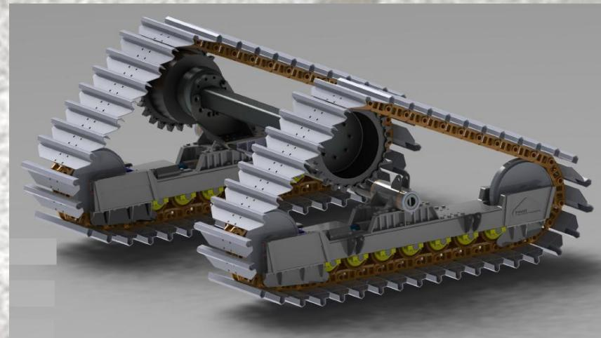
**Расшифровка маркировки :** **HT** – тяжелый трак (для тяжелых комбайнов), **STD** – стандартный трак (для легких и средний комбайнов)
