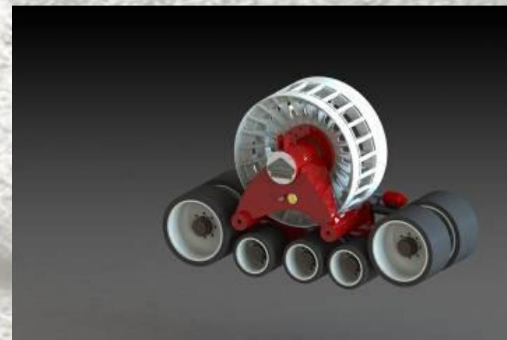
Расшифровка маркировки : ST – стальные ролики, без ST – прорезиненные ролики, СТ – 3 тандемных ролика , CTR – 2 тандемных ролика, 30 (36, 24, 16) – ширина гусеничной ленты в дюймах
