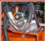
Гидравлическая система, укомплектована электромагнитными клапанами.
