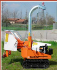
Агрегатирование измельчителя на гусеничном самоходном шасси, позволяет выполнять работы в самых стесненных условиях, где не представляется возможности проехать трактору или автомобилю.
