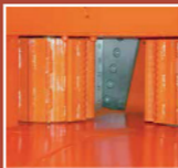
Усовершенствованная система подачи материала, выполненная в виде двух гидравлических вертикальных роликов.
