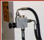
Гидравлическая система управления скоростью подачи измельчаемого материала.
